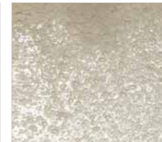
Hydrocrack Luftabscheidevermögen: 29 Sek.
