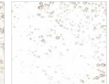
Polyalphaolefin Luftabscheidevermögen: 12 Sek.
