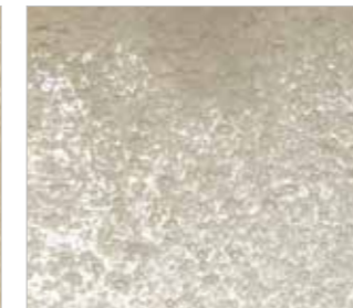
Aceite hidrocraqueado Capacidad de separación de aire: 29 Seg.
