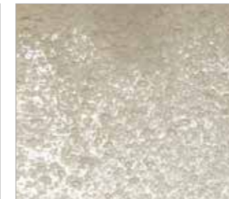
Fluide issu d'hydrocraquage Capacité de désaération : 29 Sec.
